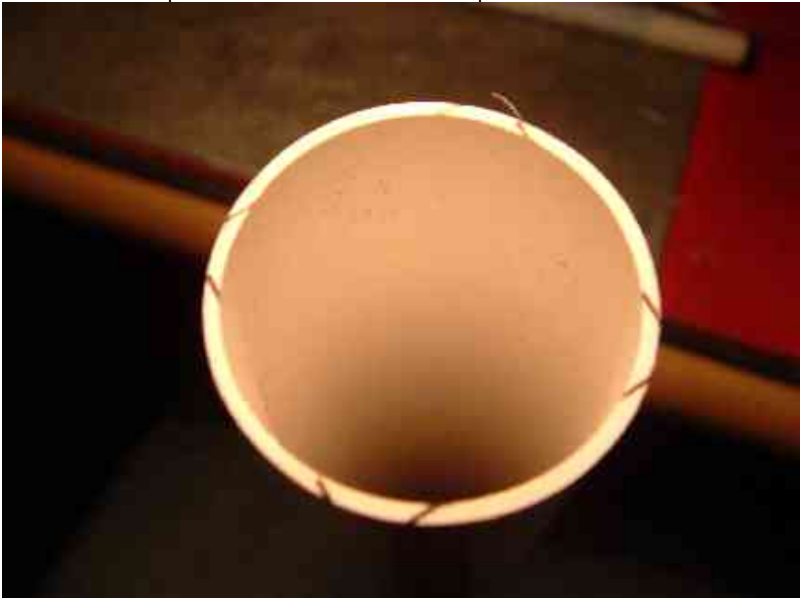
Teken de 4 hoekpunten van de N-connector af op de radome
