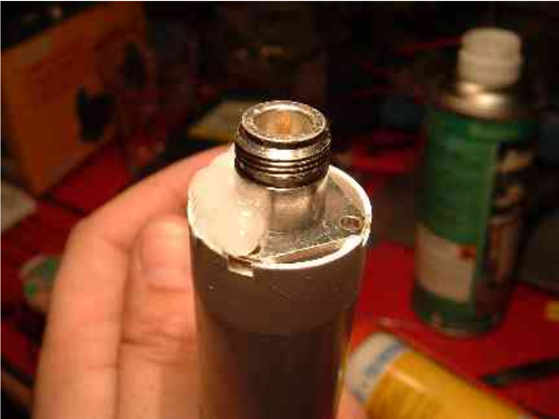
Bedek de connector met siliconen-kit
