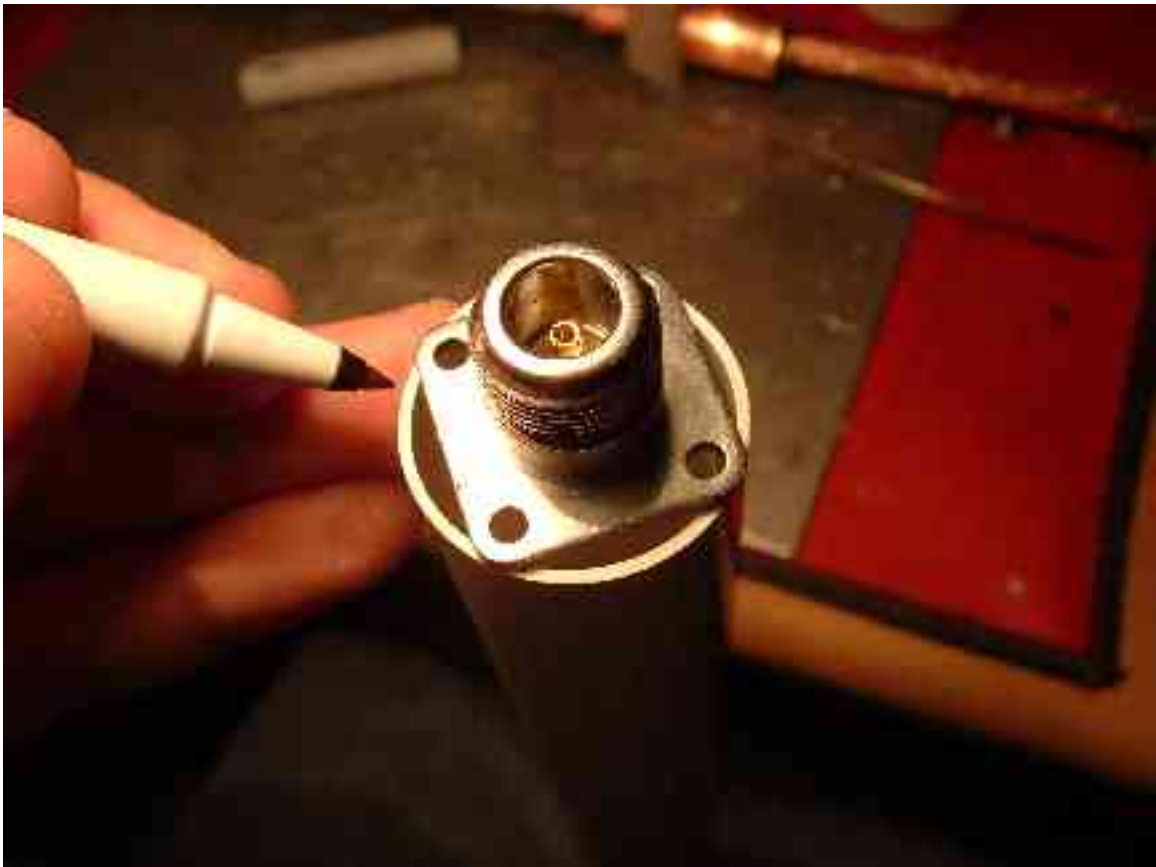
Teken de 4 hoekpunten van de N-connector af op de radome
