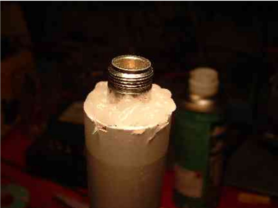
Bedek de gehele bovenkant met kit, evenals de zijkant (ca15mm)
