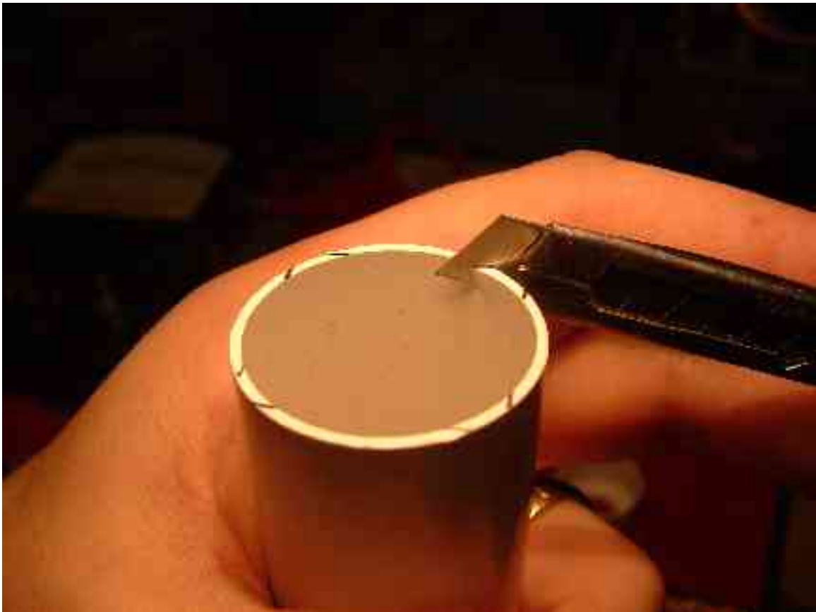
Snij in tot de dikte van de flens van de N-connector
