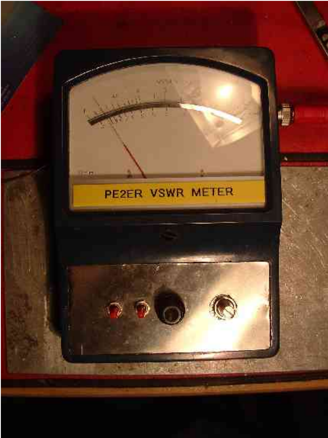
De SWR is verbeterd... van 1:1.3 naar 1:1.2 door installatie van de radome.
