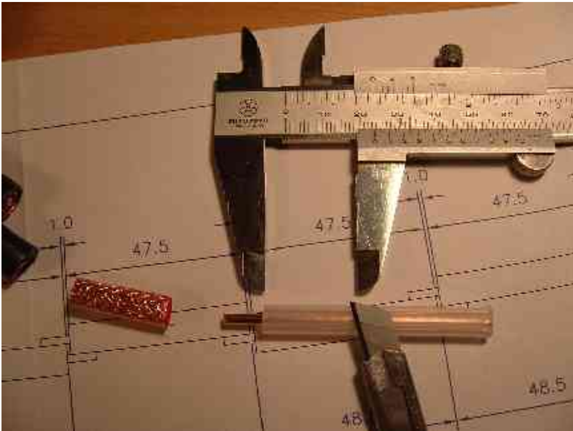
Snij de kernisolatie af op 23,75mm (dit wordt een \frac{1}{4} golf stub)
