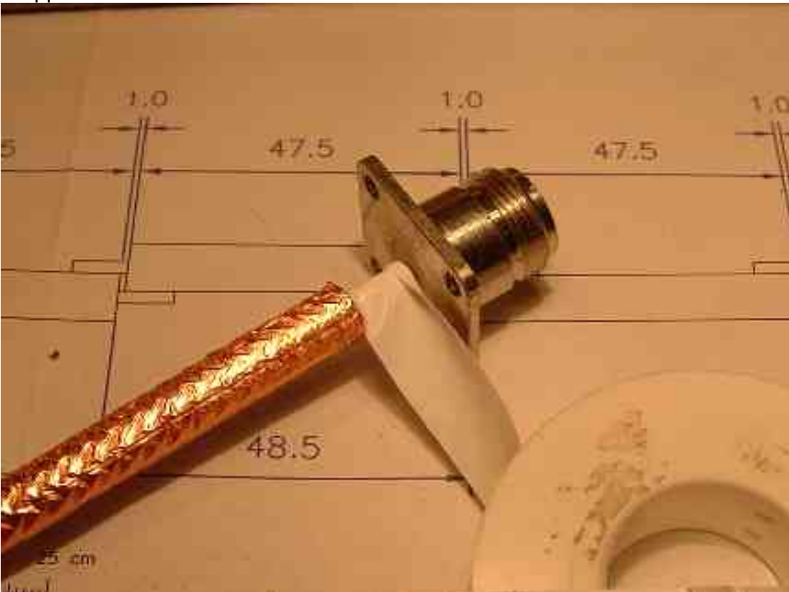
Strippen en aan de N-connector solderen
