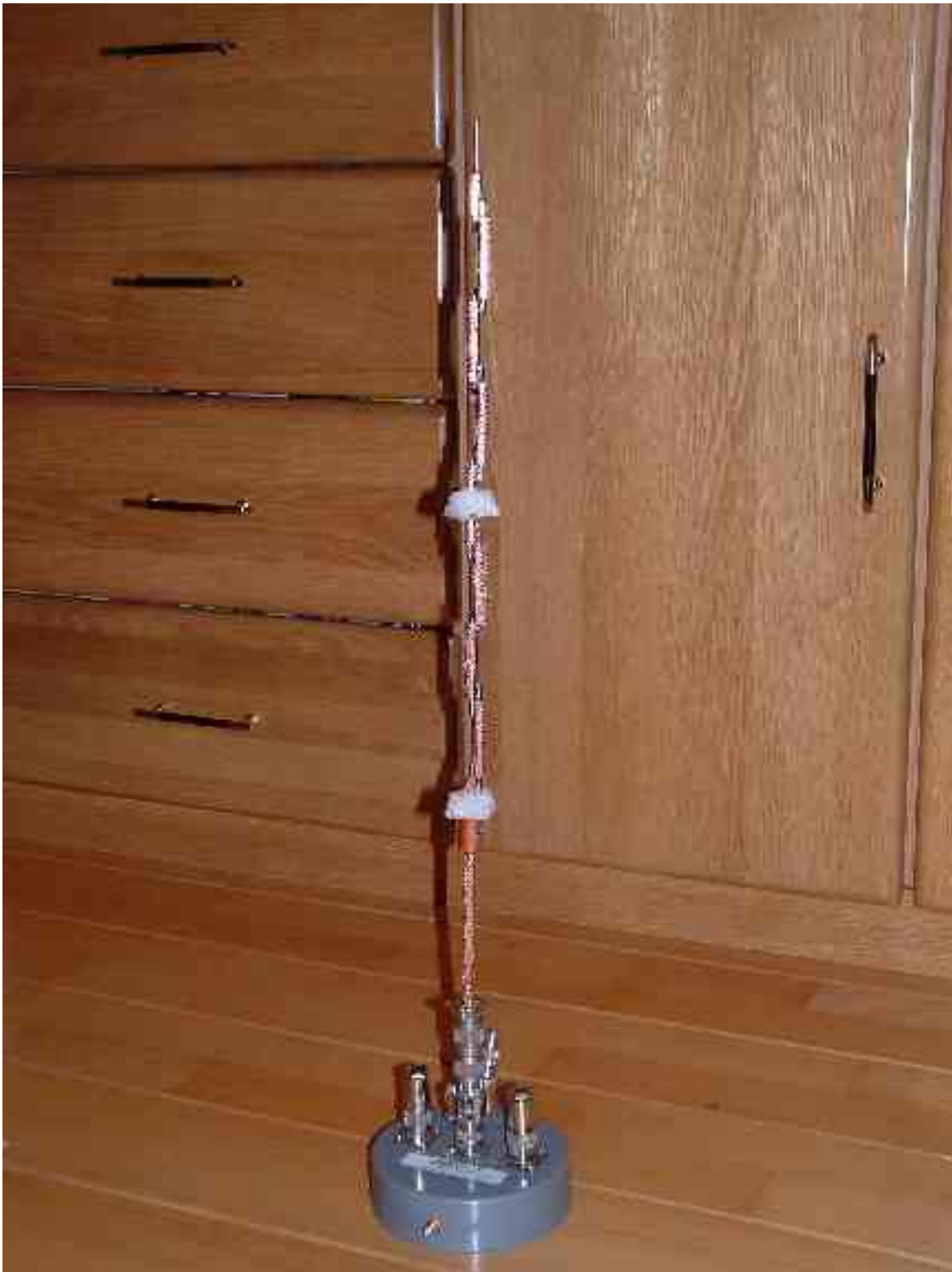
Het binnenwerk van de antenne moet met een beetje beleid zonder steun rechtop kunnen staan.
