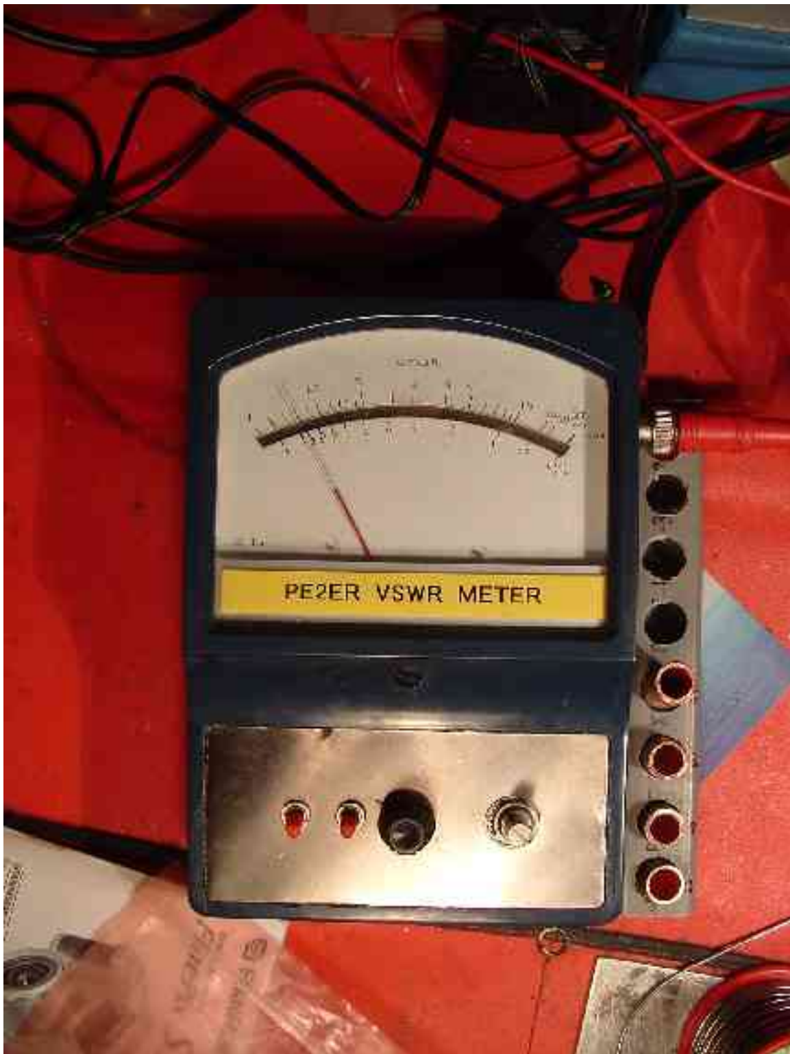
Dit exemplaar heft een SWR van 1:1.3 De PVC Radome heeft nog een (meestal gunstig) effect op de SWR.
