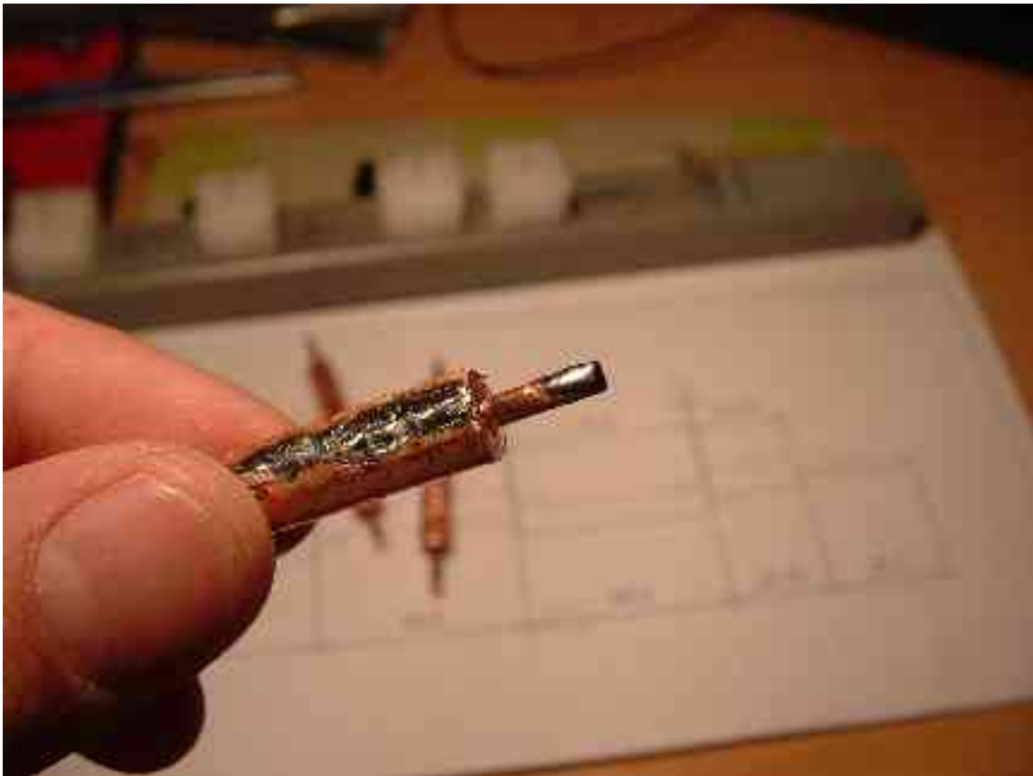
Vertin een klein stukje van de kern, aan dezelfde zijde waar de folie gesoldeerd is
