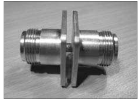
Foto 2. Verbindt de twee Female-N chassisdelen met flens met elkaar.
